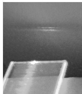
Рис. 4. Рассеяние излучения при выводе из волновода из двуокиси титана, напыленного на ниобат лития на расстоянии 2 см. Видно сильно светящийся край на конце пластины, что говорит о сильном рассеянии
