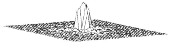
Рис.7. Распределение интенсивности на изображении, восстановленном с голограммы, рассчитанной по методу Герчберга-Секстона.
