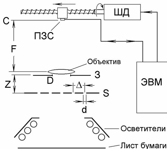
Рис.4. Экспериментальная установка.
