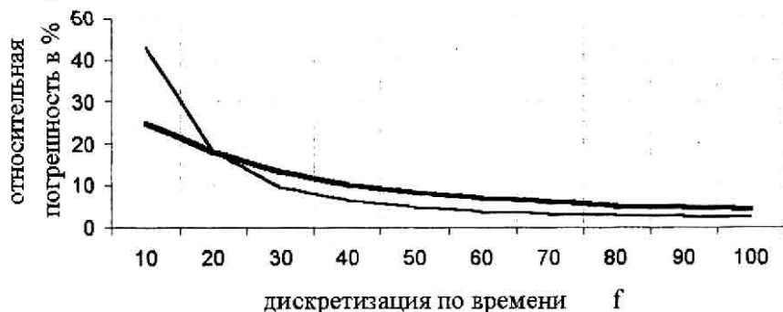
Рис. 1 Зависимость погрешностей от времени. Тонкая линия — погрешность решения с помощью схемы повышенной точности по времени, Толстая линия — погрешность решения с помощью схемы "push-pull"
