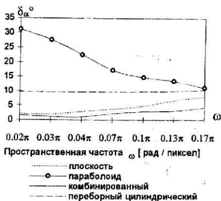
Рис.10. Зависимость погрешности оценивания поля направлений аппроксимационными методами от пространственной частоты квазипериодической структуры (маска 9x9).
