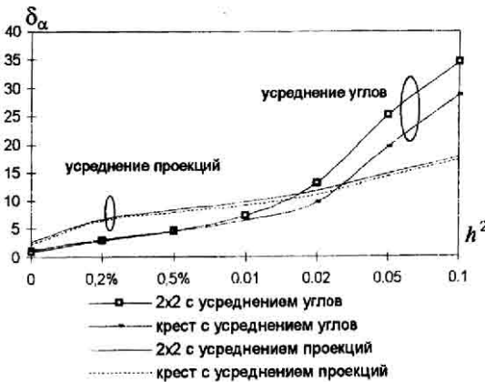
Рис. 17. Зависимость погрешности оценивания поля направления от интенсивности шума (маска 7 \times 7 ) для класса градиентных методов, использующих стандартные разностные схемы.
