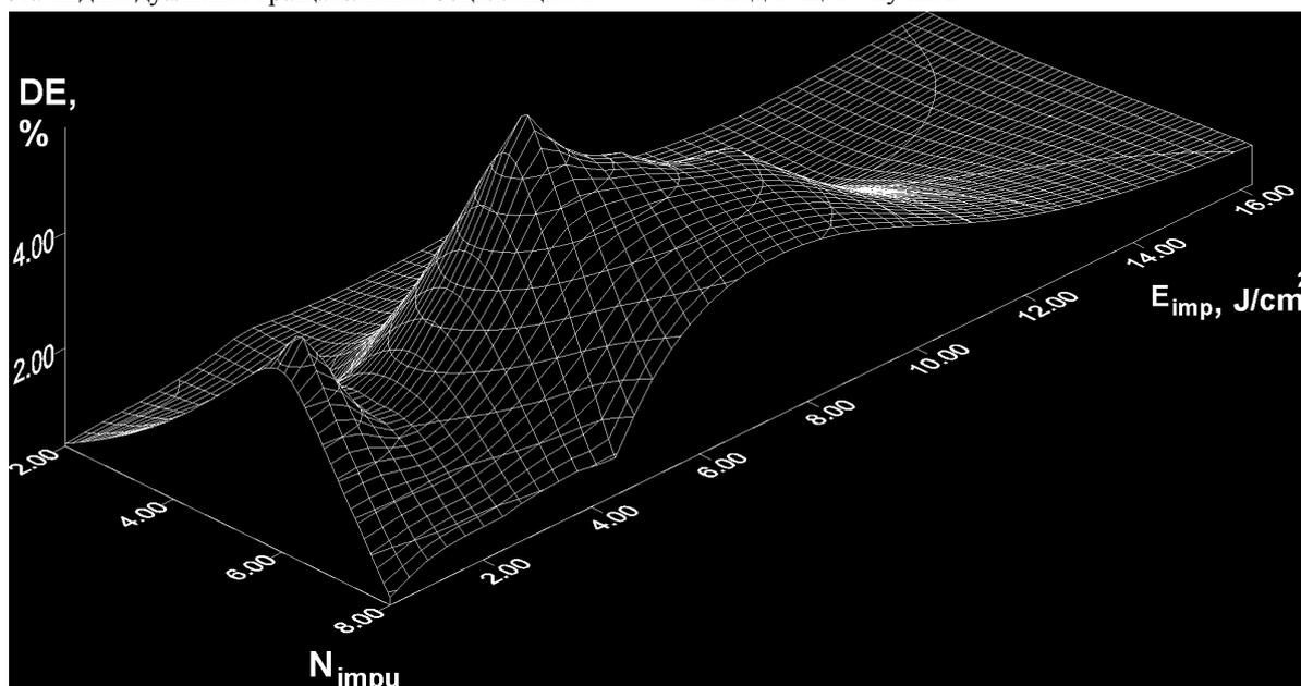
Рис. 2. Изменение дифракционной эффективности DE тест-голограммы, записанной в отожженной ИК-лазерными импульсами эмульсии СП ДЖ, от количества импульсов  $N$  и энергии в импульсе ( $E$ , Дж/см<sup>2</sup>, падающая доза)
