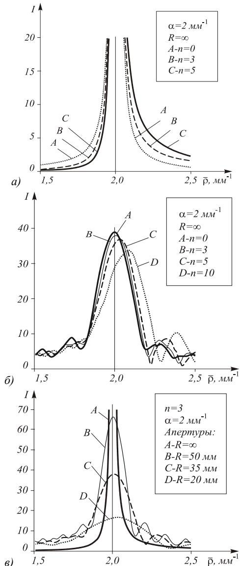
Рис. 1. Радиальное распределение интенсивности в частотной плоскости при дифракции конической волны на СФП ( $k/f = 1 \text{мм}^{-2}$ ): (а) апертура - бесконечная, различные порядки сингулярности  $n : 0$  (кривая А), 3 (кривая В) и 5 (кривая С), (б) апертура конечна ( $R=35 \text{мм}$ ), различные порядки сингулярности  $n : 0, 3, 5, 10$  (кривые А, В, С и D), и (в) порядок сингулярности  $n=3$ , различные апертуры – бесконечная (кривая А),  $R=50 \text{мм}$ , 35 мм, и 20 мм (кривые В, С, и D)
