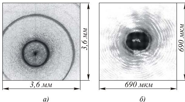
Рис. 3. Дифракция Фраунгофера от (а) конической волны (параметр аксиона:  $\alpha = 44,5 \text{ мм}^{-1}$ ) на СФП порядка  $n=5$  и (б) Гауссова пучка (радиус перетяжки:  $\sigma = 0,8 \text{ мм}$ ) на СФП порядка  $n=2$  (б)
