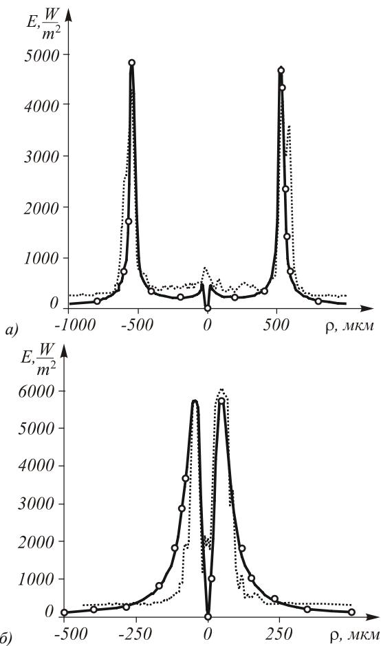
Рис. 4. Дифракция (а) конической волны и (б) Гауссова пучка на СФП. — экспериментальное и —\*— теоретическое распределение интенсивности
