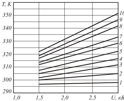
Рис. 1. Экспериментальная зависимость температуры подложки от ускоряющего напряжения: 1)- I= 1mA; 2) I=2 mA; 3) I=3 mA; 4) I=4 mA; 5) I=5 mA; 6) I=6 mA; 7) I=7 mA; 8) I=8 mA; 9) I=9 mA; 10) I=10 mA; время облучения t= 50 с
