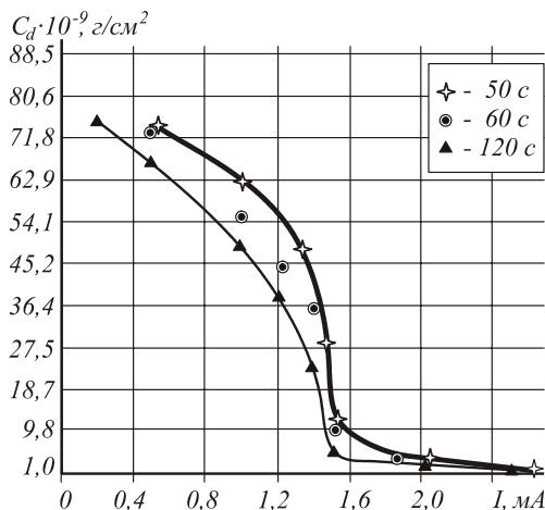
Рис. 4. Зависимость степени чистоты поверхности подложки от тока разряда:  $U = 3 \text{ кВ}$
