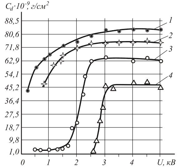
Рис. 2. Зависимость степени чистоты поверхности подложки от ускоряющего напряжения: 1 – 0,5 mA; 2 – 1 mA; 3 – 2 mA; 4 – 3 mA;  $t=10$  с
