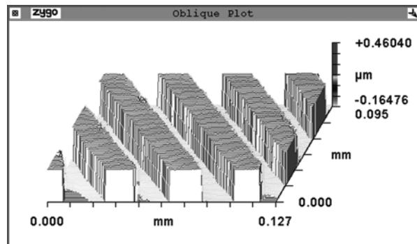
Рис. 5. Вид микрорельефа на диоксиде кремния, полученного с применением разработанной методики очистки
