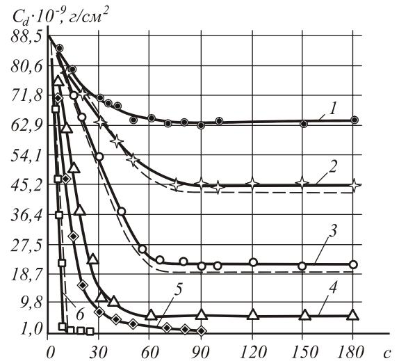
Рис. 3. Зависимость степени чистоты поверхности подложки от длительности облучения: 1 – 0,5 mA ( $t_{lim}=65$  с); 2 – 1 mA ( $t_{lim}=60$  с); 3 – 1,4 mA ( $t_{lim}=50$  с); 4 – 1,5 mA ( $t_{lim}=30$  с); 5 – 2,6 mA ( $t_{lim}=20$  с); 6 – 3 mA ( $t_{lim}=10$  с);  $U = 3$  кВ; штриховыми линиями показана зависимость (14)
